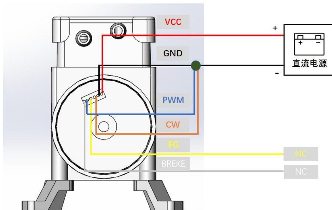
图 3-1 定速简易接线示意图
