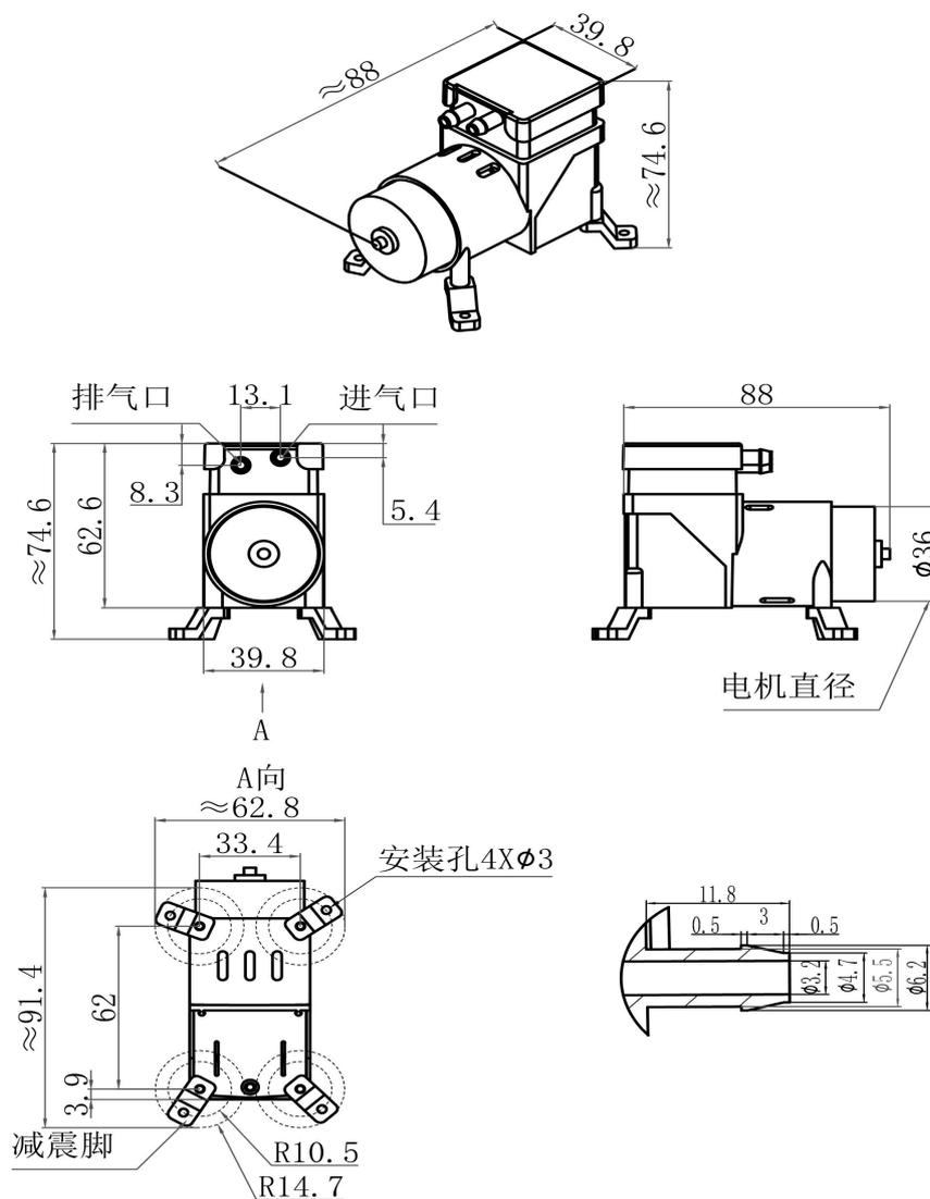
4个减震脚可绕螺钉转动
