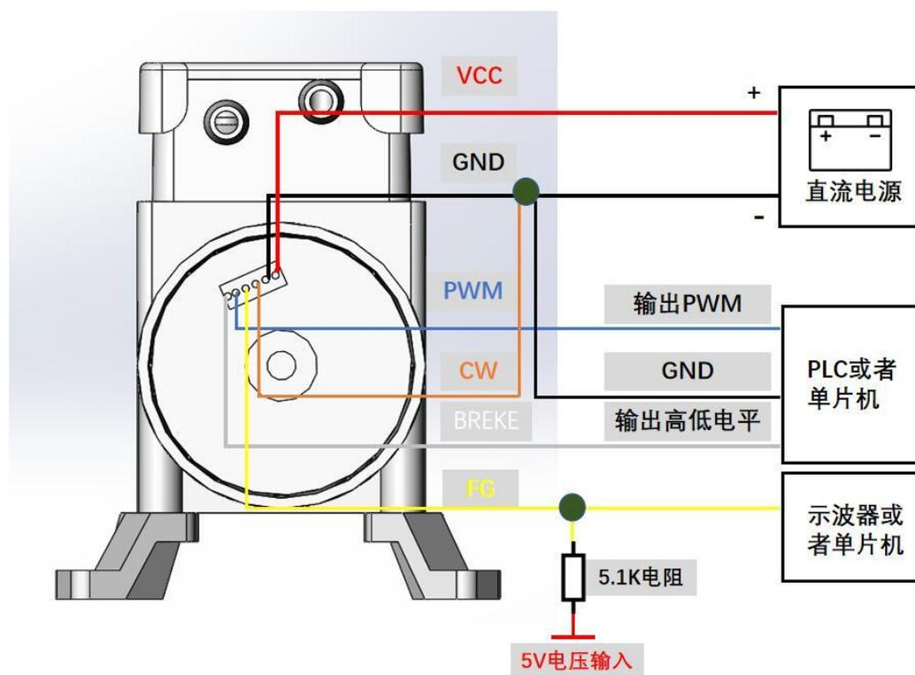
图 3-3 PWM 调速、FG 反馈接线示意图
