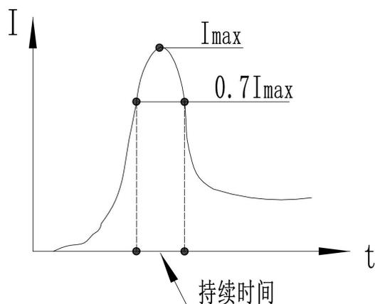
图 3-5 启动电流示意图
