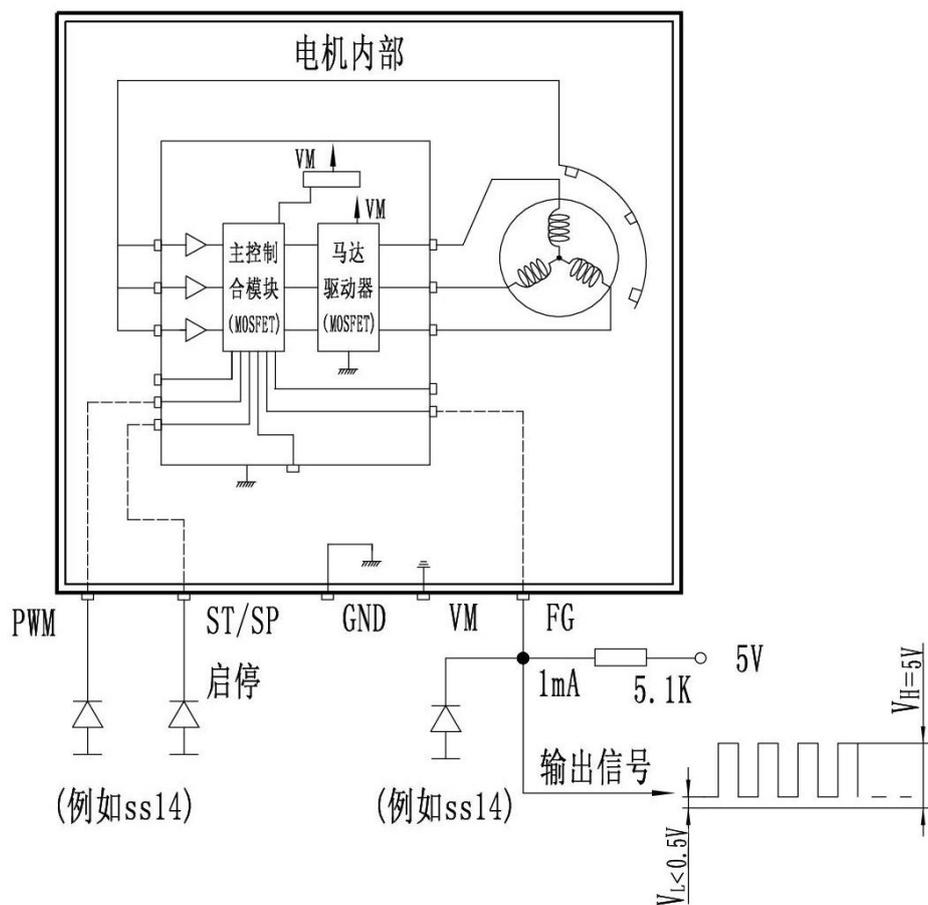
图 3-4 电机电气原理图
