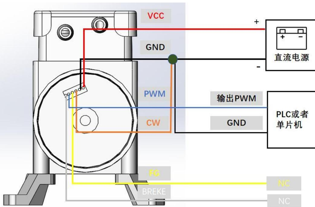
图 3-2 PWM 调速接线示意图
