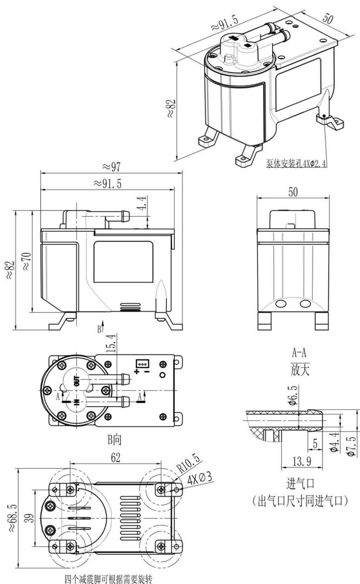
**安装说明：**图中减震脚为赠品，请客户根据需要自行安装！安装孔为自攻螺钉孔，禁止反复拆卸！不然会导致安装松动、不可靠。
