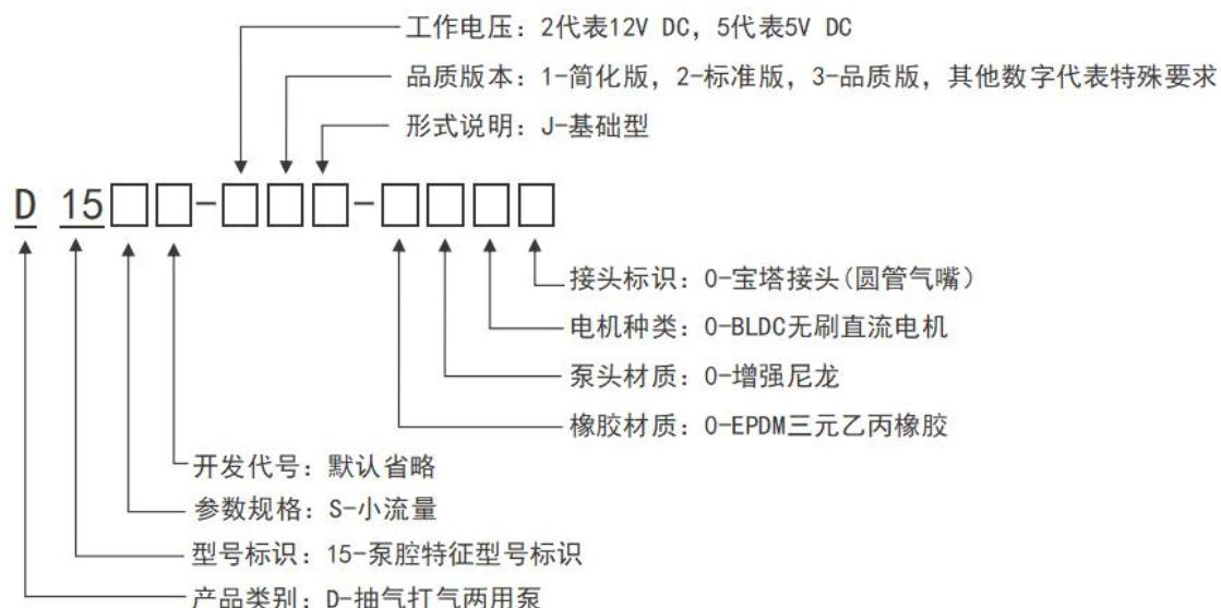
示例 1: D15S-51J-0000 (D15S 泵, 5V 电压基础型简化版)
