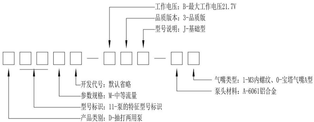
示例：D11M-B3J-A1（D11M 气泵，21.7V，基础型品质版，铝合金泵体，M3 内螺纹接头）
