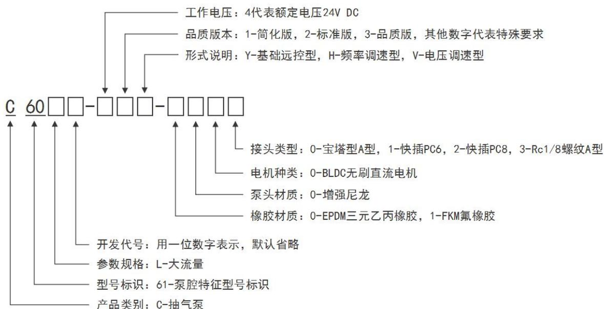
示例 1：C61-41Y-0000（C61 泵，24V 电压基础远控型简化版）
