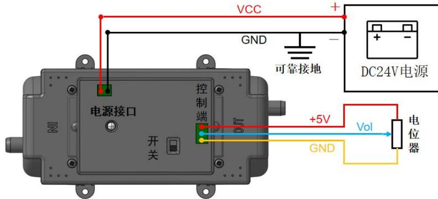
图 5-3 电压调速型接线说明
