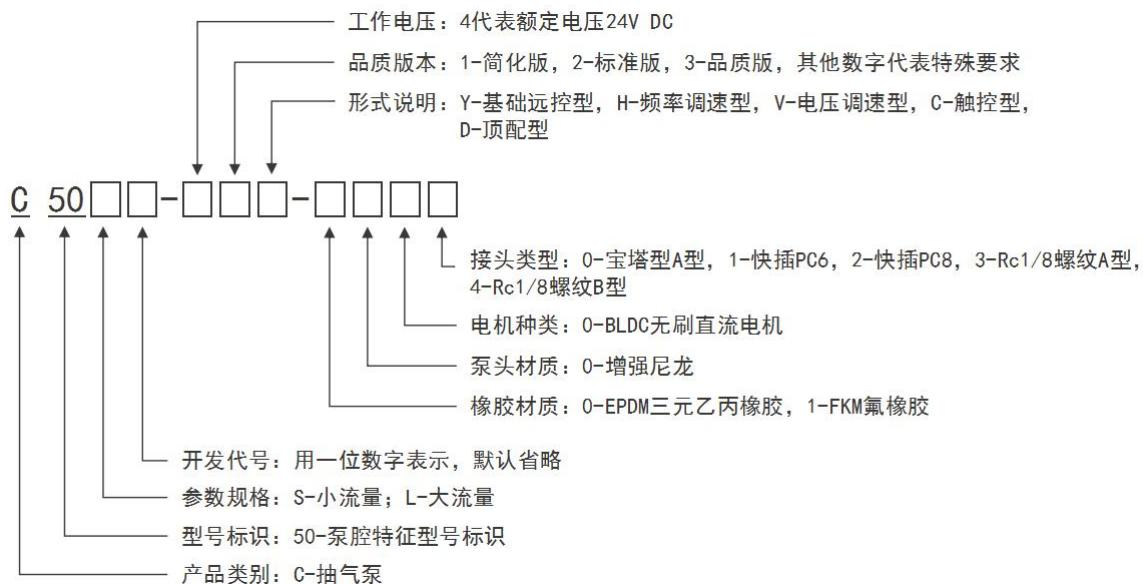
示例 1: C50S-41Y-0000 (C50S 泵, 24V 电压基础远控型简化版)
