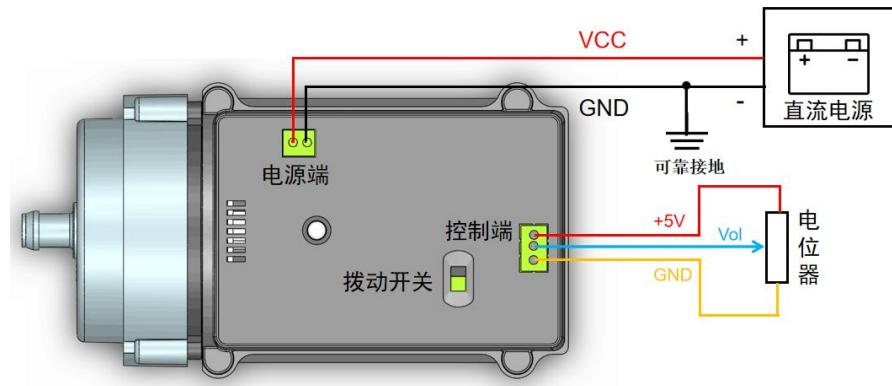
图 5-3 电压调速型接线说明
